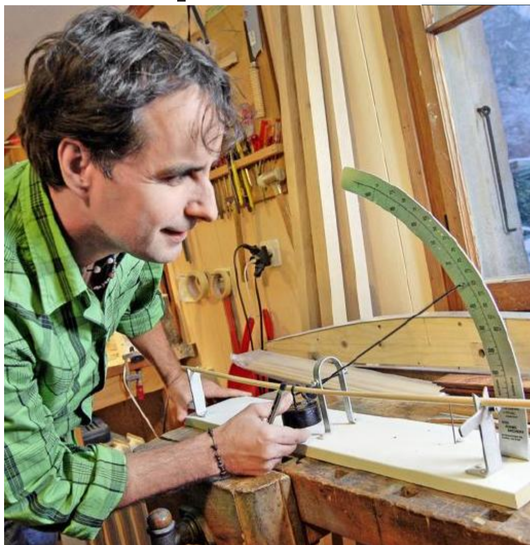
Olivier Grieb (photo de g.), en train de vérifier la rigidité d'une flèche, et Denis Droz, qui démoule une branche, partagent le même savoir-faire et la même passion.
